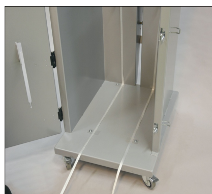
Banden dras längs med kammargolvet och fästs på dörrens framsida.
