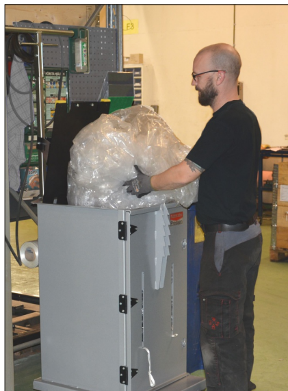
Lägg i materialet uppifrån och fäll ner pressplattan för komprimering.
