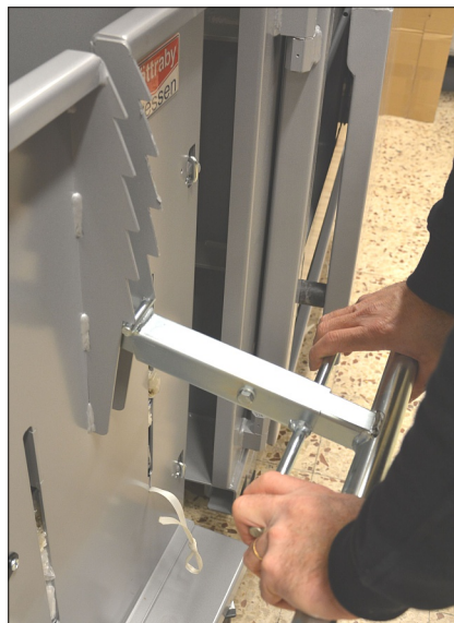
Pressplattan stannar i nedre läge och pressar ut luften, vilket ger kompakta balar. Det smarta låset kan enkelt lossas.
