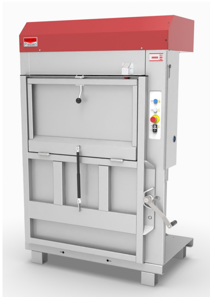
Tack vare sin låga höjd kan NP60-II placeras nära källan för det pressbara materialet och är enkel att flytta med en handtruck vid ändrade behov.
